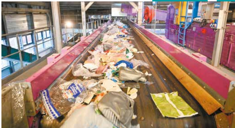
→ Nos déchets, triés puis collectés, sont transportés au centre de tri du Sycotm à Nanterre où ils sont à nouveau triés, séparés et classés par matière, au rythme de 17 tonnes par heure..
